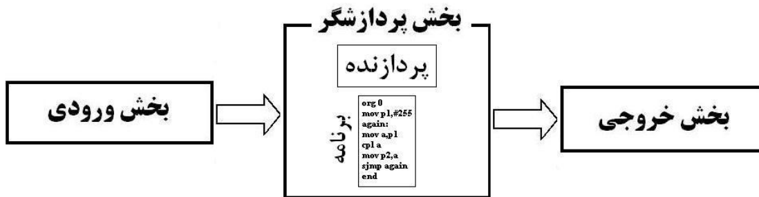
شکل ۱-۵ - یک سیستم کنترلی مبتنی بر پردازنده
