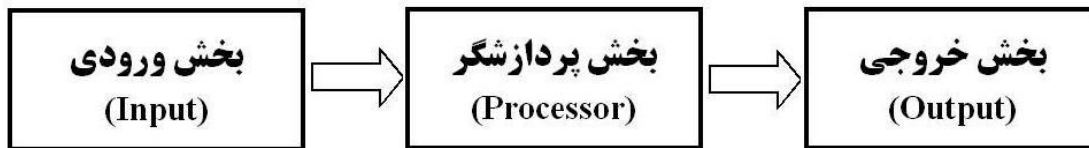
شکل ۱-۱- اجزاء یک سیستم کنترلی
