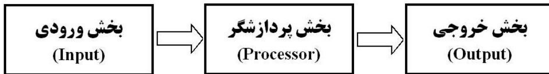
شکل ۱-۱- اجزاء یک سیستم کنترلی
