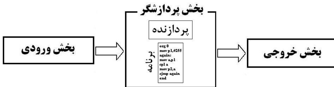
شکل ۱-۵ - یک سیستم کنترلی مبتنی بر پردازنده
